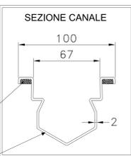
Acciaio Aisi 304 (a richiesta Aisi 316) - Spessore costruttivo 2 mm
