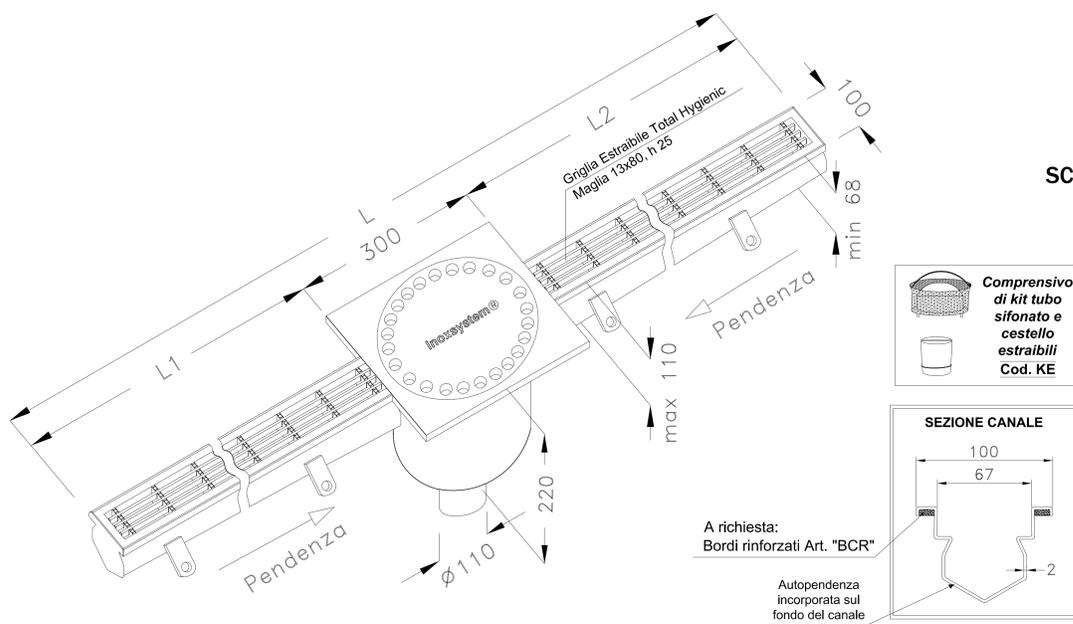
Acciaio Aisi 304 (a richiesta Aisi 316) - Spessore costruttivo 2 mm
