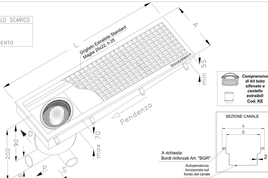
Acciaio Aisi 304 (a richiesta Aisi 316) - Spessore costruttivo 2 mm
