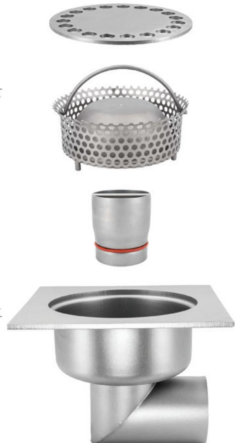
Tuyau-siphon et panier amovibles permettent un accès total au siphon qui peut être facilement nettoyé. Après nettoyage, il est fortement recommandé de remplir le siphon avec de l'eau afin d'éviter les remontées de mauvaises odeurs.
