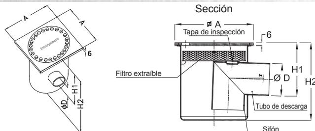
Inoxsystem® IDrain 0011 - Sumidero sifónico con rejilla perforada espesor 6 mm de forma cuadrada - salida horizontal ultra-rebajada - filtro extraíble
