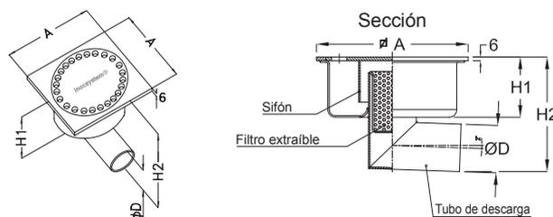
Inoxsystem® IDrain 0010 - Sumidero sifónico con rejilla perforada espesor 6 mm de forma cuadrada - salida horizontal - filtro extraíble
