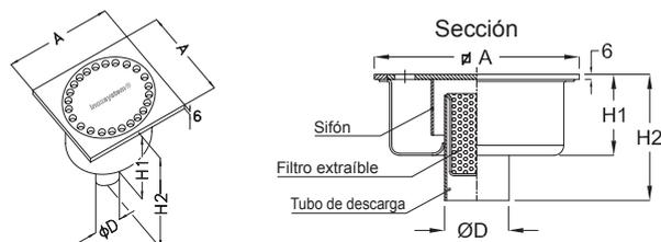
Inoxsystem® IDrain 0013 - Sumidero sifónico con rejilla perforada espesor 6 mm de forma cuadrada - salida vertical - filtro extraíble
