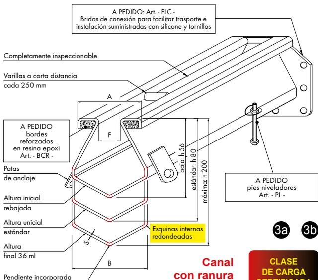
**Canal con ranura Inoxsystem® art. "C2" con bordes reforzados BCR tiene certificación CLASE DE CARGA D400**
