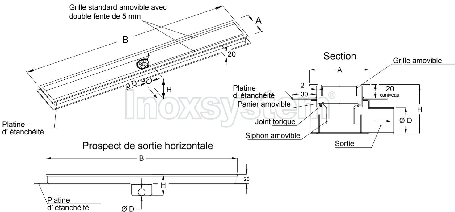
**Inoxsystem® IDrain 3090 - Caniveau de douche siphonné avec grille standard à double fente - largeur 70 mm - Bords visibles - sortie Ø 40 centrale horizontale - siphon et panier amovibles - platine d'étanchéité**
