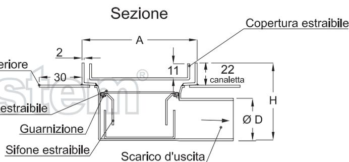
Inoxsystem® IDrain 3270 - Canaletta con copertura pavimentabile a doppia fessura - Larghezza mm 84 - Senza bordi - scarico Ø 40 centrale orizzontale - sifone e filtro estraibili - Con profilo inferiore in acciaio inox per isolamento su massetto di posa.
