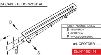
**DESAGUADERO CON RANURA SOBREPOSICIONABLE PARA CANALES EN HORMIGÓN U OTRAS COMPOSICIONES**
